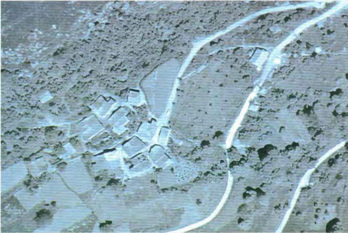
La ortoproyección se realiza en un ortoproeyector que hace la rectificación diferencial de la imagen, guiado por la cinta magnética que contiene los perfiles del terreno.
